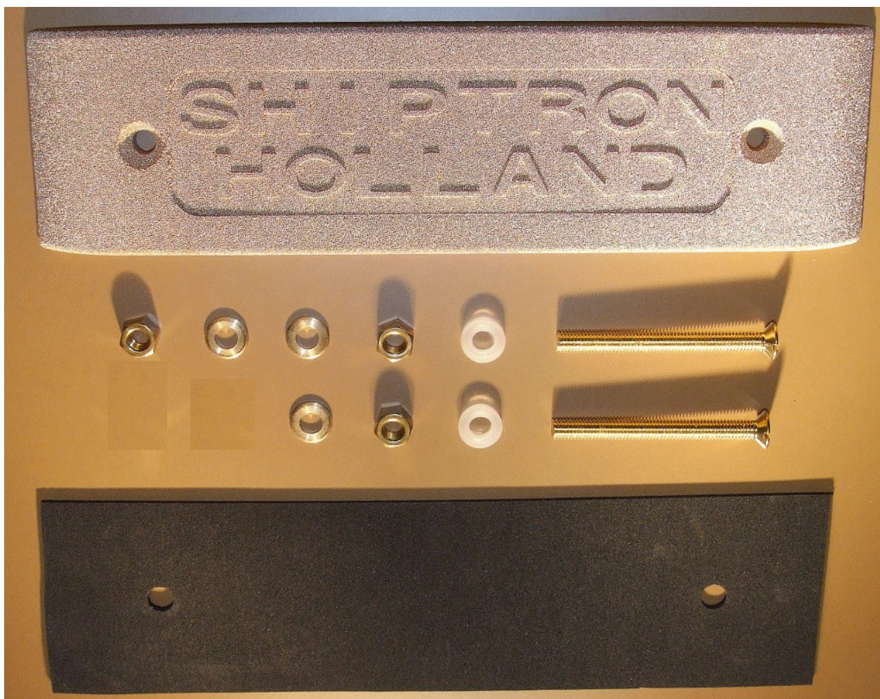
AARDPLAAT pakket 300 x 80 x 15 mm met bronzen bouten en pakking
